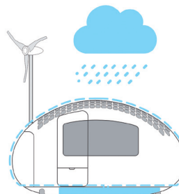
Zber dažďovej vody Rainwater collection
