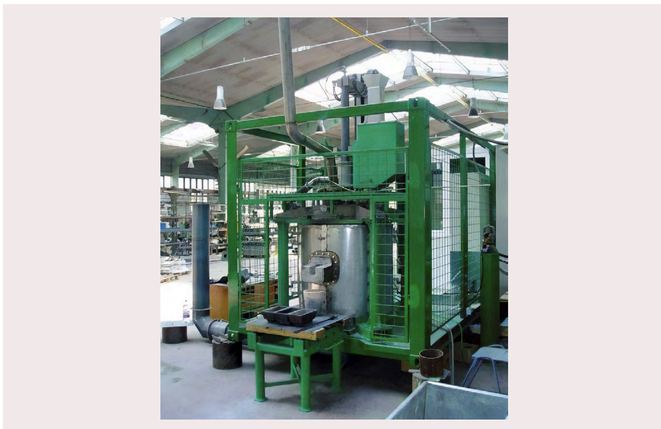
Obrázok 4: Kontajnerový plazmový reaktor s výkonom 80 kW
