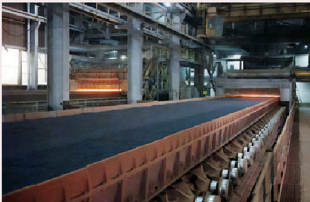
Obrázok 1: Dwight-Lloydov spekací pás ( Bref dokument I&S )
