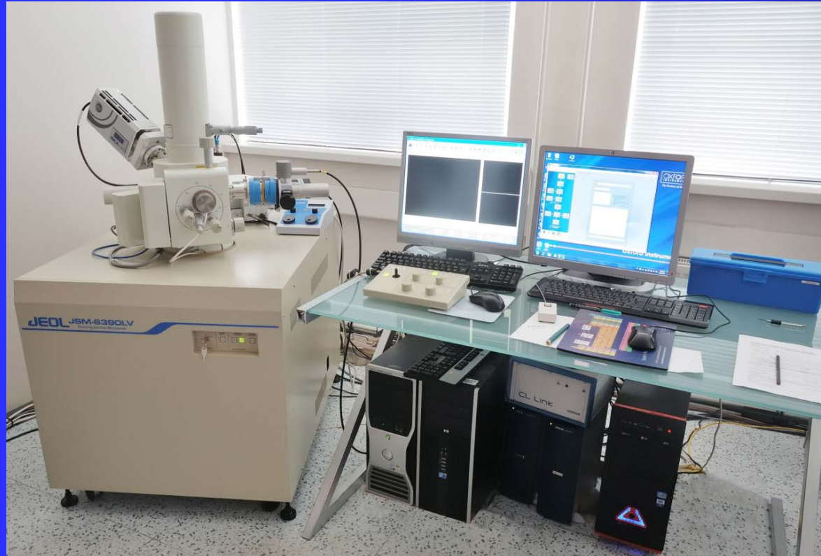
Elektrónový mikroskop JEOL JSM-6390LV s EDS spektrometrom OXFORD Instruments INCA a katódovo-luminiscenčným spektrometrom HORIBA Fázová a chemická mikroanalýza
