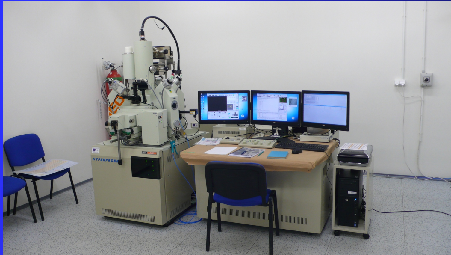
FEG mikrosonda JEOL JXA-8530F Chemická mikroanalýza a mapovanie
