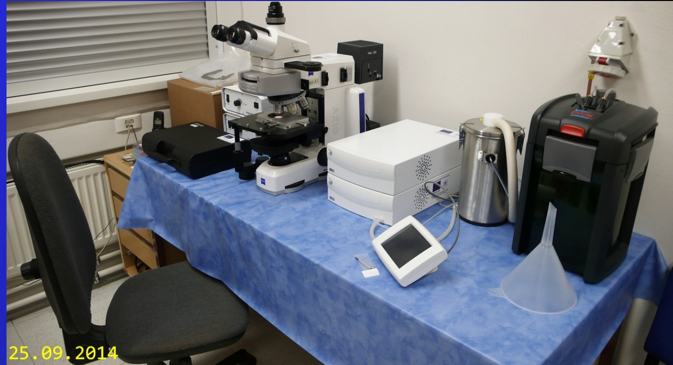
Mikroskop ZEISS AxioScope.A1 s termokryometrickou komorou Linkam FTIR600 Fluidné inklúzie
