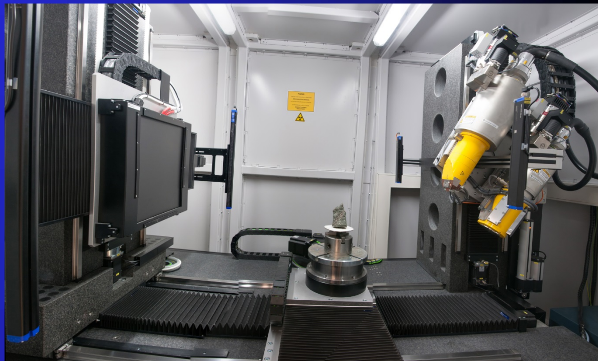
Mikrotomograf Phoenix v|tome|x L 240 (General Electric) Nedeštruktívna 3D analýza
