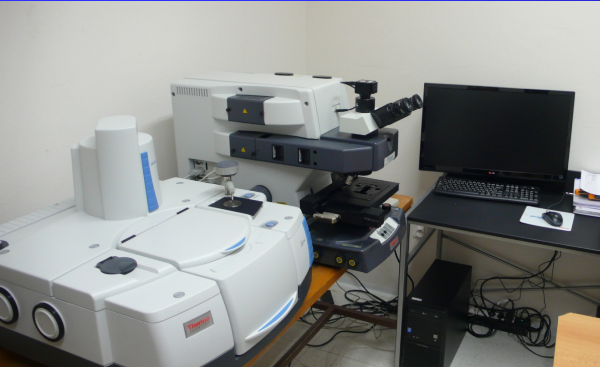
FTIR spektrometer Thermo Nicolet iS50 s infračerveným mikroskopom Continuum Fázová a chemická mikroanalýza
