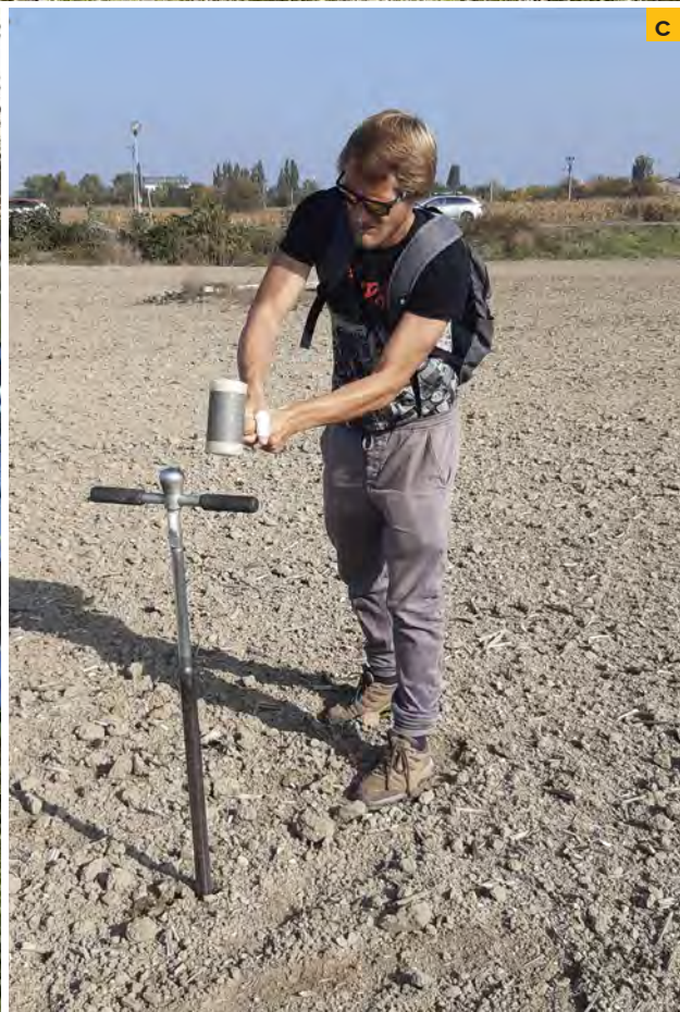
3 a) Vítanie atmogeochemickej sondy pomocou zemiého vrtáka, b) Meranie znečistenia pôdneho vzduchu pomocou prístroja ECOPROBE 5, c) Hĺbenie atmogeochemickej sondy pomocou žliabkového vrtáka
