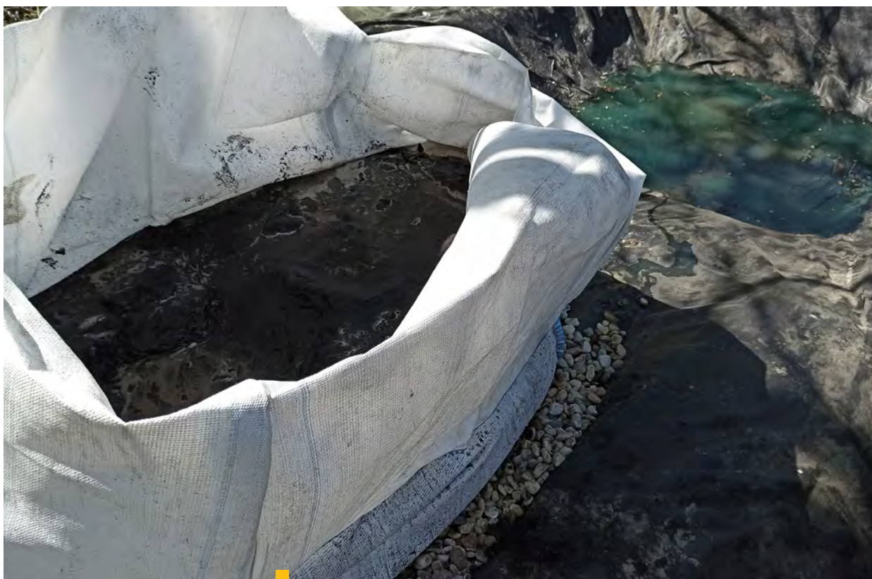
10 Testy lúhovania ex-situ s perkoláciou v big-bagu. Biologicko-chemické testy lúhovania ex-situ boli uskutočnené za nesterilných podmienok v prírodných klimatických podmienkach na halde a v big bagoch, ktoré boli každý deň skrúpané najúčinnejším médiom CHL pozostávajúcím z biogénnych prvkov. V záverečnej fáze biolúhovania bol do média pridaný 1% H_2O_2 . Získané výluhy boli periodicky vzorkované a analyzované na stanovenie obsahu sledovaných kovov v roztoku. Išlo o arzén, bárium, meď, olovo, antimón a zinok.
