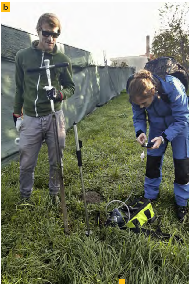
3 a) Vítanie atmogeochemickej sondy pomocou zemiého vrtáka, b) Meranie znečistenia pôdneho vzduchu pomocou prístroja ECOPROBE 5, c) Hĺbenie atmogeochemickej sondy pomocou žliabkového vrtáka
