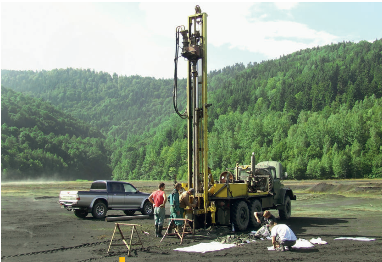
5 Prieskumné vrtné práce na odkalisku Slovinky. Vo vrchnej časti odkaliska je súvislá vrstva jemnozrnnej priemyselnej strusky o hrúbke cca 5 až 6 m z Kovohút Krompachy. Povrchová vrstva nie je zrekultivovaná, ide o tzv. suché odkalisko.
