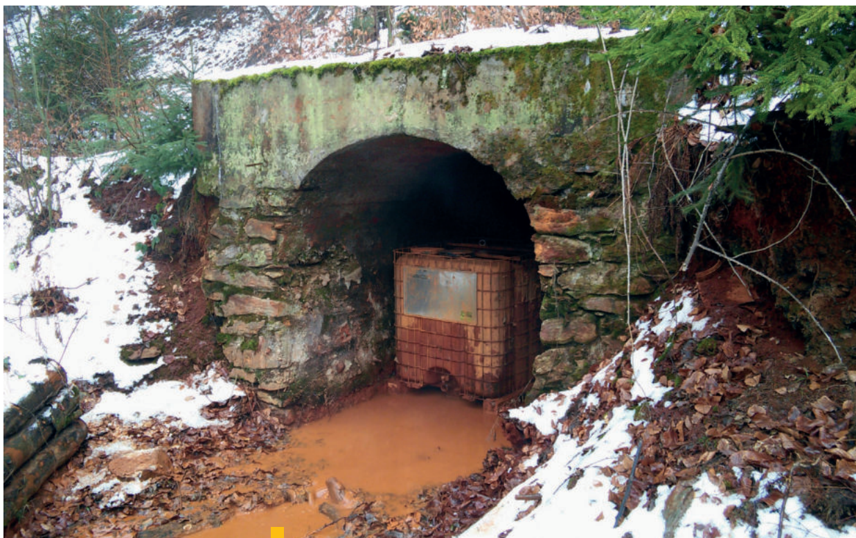
1 Poproč – štôlna Agnes s experimentálnymi kontajnermi na pasívne čistenie banských vôd (2015)
