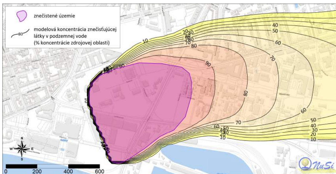
Obr. 4 – Modelové koncentrácie látky pri dlhodobom pôsobení zdroja znečistenia pri transporte bez podzemných stien
