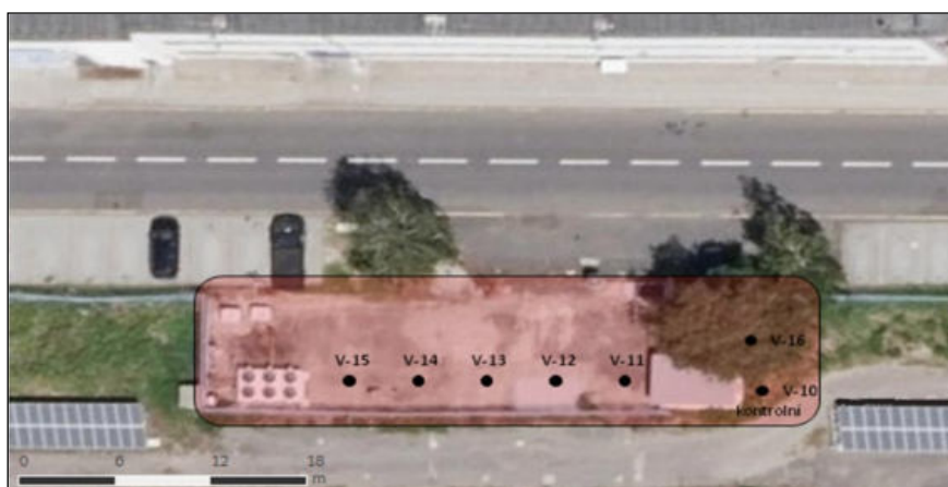
Obr. 1: Přehled aplikačních vrtů a jejich přibližná lokalizace v ohnisku kontaminace
