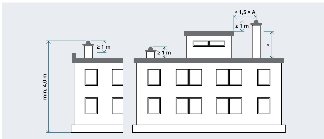
Obrázok 8: Poloha ústia komína v prípade plochej strechy, resp. strechy so sklonom menej ako 20°
