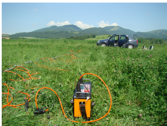
Obr. 2: Meranie pôdnej rezistivity na lokalite Nemce
