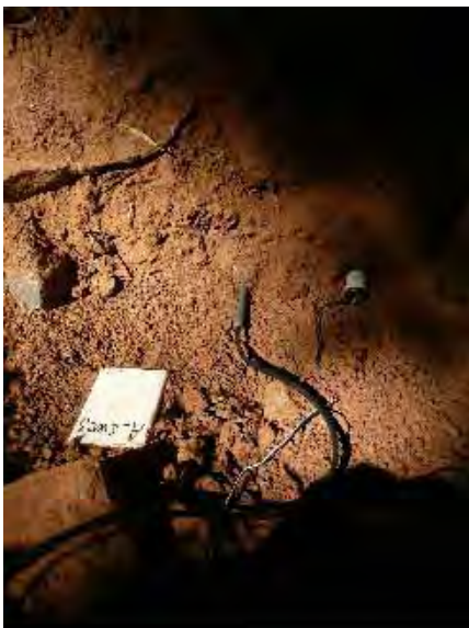
Obr. 3.96 Senzory na meranie objemovej vlhkosti pôdy, teploty pôdy a pôdneho potenciálu a dataloger na lokalite TMP Železnô (foto Z. Sitková)
