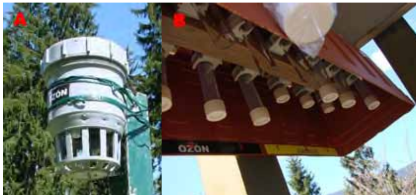
Obr. 3.65 Typy krytov použité na meranie znečistenia ovzdušia pasívnymi filtermi v roku 2009. A – originálny typ fy Gradko, B – kryt vlastného dizajnu na 6 – 12 túb (foto H. Pavlendová)
