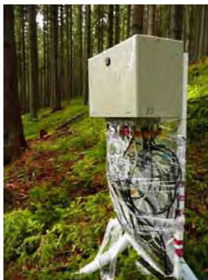
Obr. 3.96 Senzory na meranie objemovej vlhkosti pôdy, teploty pôdy a pôdneho potenciálu a dataloger na lokalite TMP Železnô (foto Z. Sitková)
