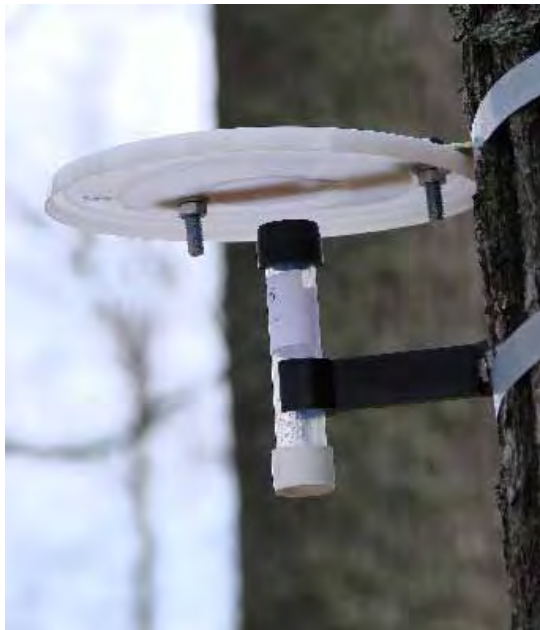
Obr. 3.60 Pasívny sampler na meranie koncentrácií ozónu firmy Gradko, Ltd. (foto H. Pavlendová)
