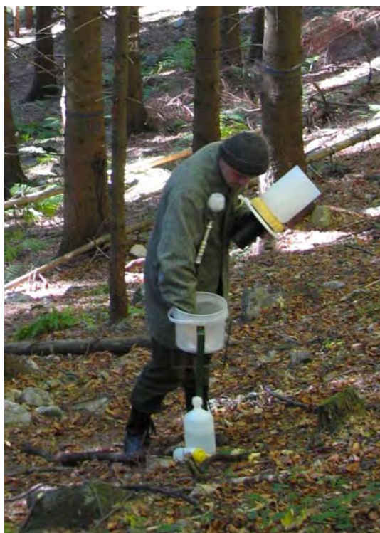
Obr. 3.47 Odber podkorunových zrážok na TMP Lomnistá dolina (foto V. Čaboun)
