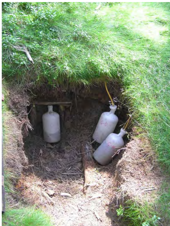
Obr. 3.68 Zber lyzimetrických vôd na TMP Grónik (foto V. Čaboun)
