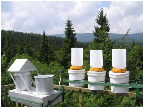
Obr. 3.31 Veža na TMP Poľana slúži aj na odber atmosférických zrážok (foto V. Čaboun)
