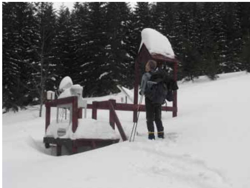
Obr. 3.39 Zariadenie na meranie depozície na TMP Lomnistá dolina
