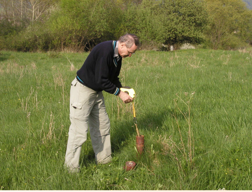
Meranie hladiny podzemnej vody Rangovou písťalou Automatický hladinomer MARS 4
