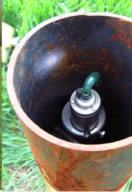
Meranie hladiny podzemnej vody Rangovou písťalou Automatický hladinomer MARS 4
