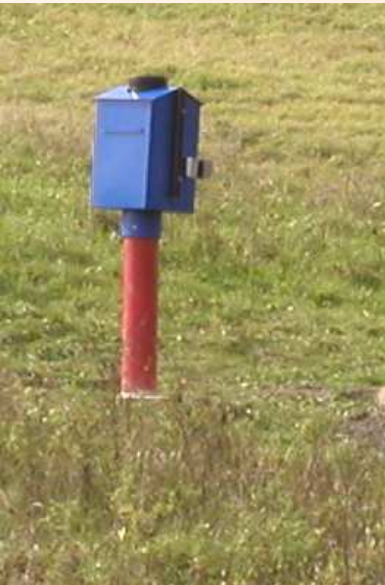
Automatický hladinomer MARS 5 s funkciou on-line prenosu údajov
